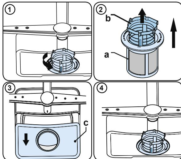
Da biste uklonili i očistili kombinaciju filtera, okrenite je u smjeru suprotnom od kazaljke na satu i uklonite je podižući prema gore (1). Izvucite grubi filter iz mikrofiltra (2). Zatim povucite i uklonite metalni filter (3). Isprati filter s puno vode sve dok ne ostane bez ostataka. Ponovno sastavite filtre. Zamjenite filterski umetak i zakrenite ga u smjeru kazaljke na satu (4).
