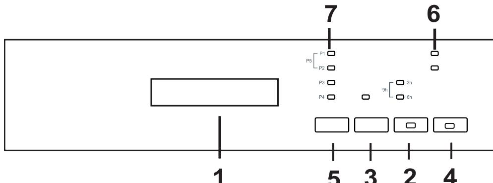
Pritiskom tipke za uključivanje/isključivanje (**4**) uključite perilicu. Svjetlo za uključeno/isključeno stanje svijetlit će sve dok je perilica uključena. Odaberite odgovarajući program pritiskom tipke za odabir programa (**5**).
