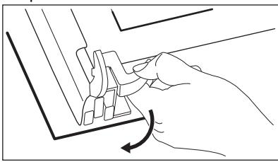
5. Okrenite pričvrstne elemente pod kutom od 90° i izvucite ih iz ležišta.
