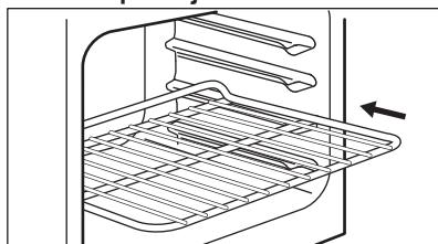
Mrežo potisnite med vodili nosilca rešetk in poskrbite, da bodo nožice obrnjene navzdol.
