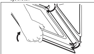
4. Stavite vrata na mekanu krpnu na stabilnu površinu i otpustite sustav zaključavanja kako biste uklonili unutarnju staklenu ploču.
