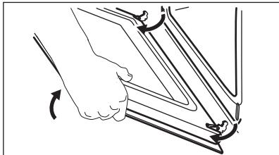
4. Vrata položite na mehko krpo na trdno površino in sprostite sistem zapiranja, da boste lahko odstranili notranjo steklena ploščo.
