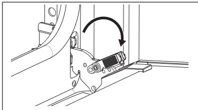
3. Zaprite vrata pečice do polovice do prvega položaja odpiranja. Potem jih dvignite in povlecite, da jih snamete s tečajev.
