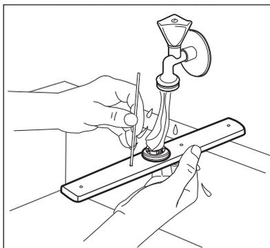
4. Pour réinstaller le bras d'aspersion, insérez la fixation dans le bras d'aspersion et insérez-le dans le conduit en le tournant vers la gauche. Assurez-vous que la fixation
