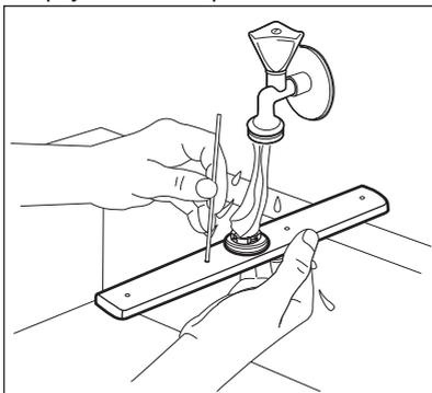
4. Za vraćanje mlaznice, umetnite element za montažu u mlaznicu i pričvrstite je u utor okretanjem u smjeru obrnutom od kazaljke na satu. Pazite da element za montažu sjedne na mjesto.
