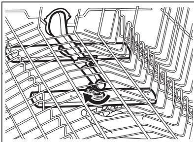
3. Operite mlaznicu pod tekućom vodom. Upotrijebite tanak šiljasti alat, npr. čačalicu, za uklanjanje čestica prljavštine iz rupa.
