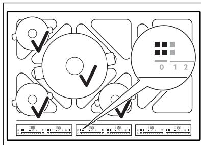
Za zgoraj navedeno kombinacijo so na voljo štiri aktivne upravljalne vrstice. Levo sprednjo posodo označuje indikator A na prvi upravljalni vrstici. Levo zadnjo posodo označuje indikator B na drugi upravljalni vrstici. Srednja posoda je prikazana z indikatorji A B C D na tretji upravljalni vrstici. Desna sprednja posoda je označena z indikatorjem C na četrti vrstici.
