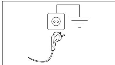
Kabel električnog napajanja nakon postavljanja uređaja mora biti lako dostupan.
