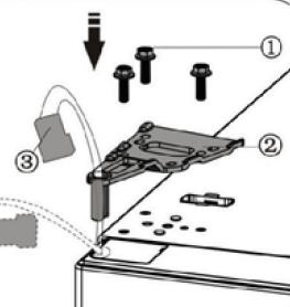
16. Spojite električni konektor 1, kao što je to prikazano na slici. Zatim vijcima 3 pričvrstite dio 2; pogledati 2. korak.
