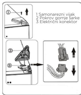
3.Odstranite vijke 1 i šarku 2. Nakon toga provucite konektor 3 kroz otvor u šarki br. 2. (Skrećemo pažnju da tijekom postavljanja vrlo oprezno držite gornja vrata).
