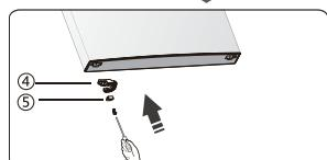
11.Zamijenite pokrove otvora za vijke, te premjestite srednju pokrivnu pločicu s lijeve na desnu stranu (kao što je to prikazano na donjoj slici).
