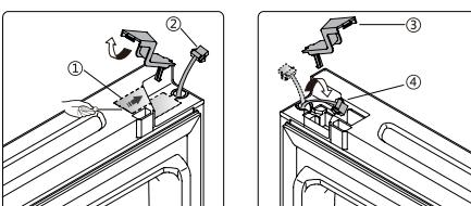
8.Otpustite vijak (3) i skinite dio (2) i dio (1). Vijkom 3 pričvrstite pričuvni graničnik vrata na lijevoj strani 4, te blokirni dio 5 (priloženi su u plastičnoj vrećici) na lijevoj strani. Spremite dijelove 1 i 2, ako vam zatrebaju kada kasnije.
