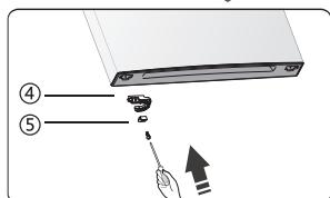
9.Usadnim ključem - imbusom (priloženim u plastičnoj vrećici) i križnim odvijačem odvijte vijke i skinite srednju šarku na desnoj strani. Zatim skinite donja vrata.
