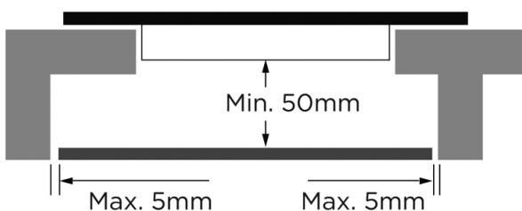
Budite sigurni da staklokeramička ploča za kuhanje ima dobru ventilaciju te da ulaz i izlaz zraka nisu blokirani. Kako bi se izbjeglo slučajno dodirivanje pregrijanog dna ploče ili neočekivanog strujnog udara tijekom rada, potrebno je staviti drveni umetak, pričvršćen vijcima, na minimalnoj udaljenosti od 50 mm od dna ploče za kuhanje.
