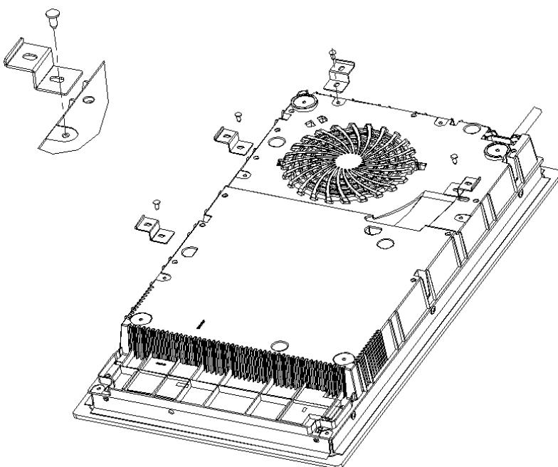
Pritegnite četiri stezača pomoću vijaka na donju stranu kućišta staklokeramičkog kuhalo. Podesite položaj stezača prema različitoj debljini radne površine.
