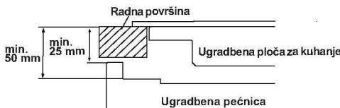
Ako pećnicu ugrađujete ispod ploče za kuhanje, razmak između radne površine i gornjeg dijela ploče pećnice mora biti minimalno 50 mm, a razmak između radne površine i gornjeg dijela upravljačke ploče mora biti minimalno 25 mm.
