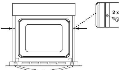
Pećnicu umetnite u kuhinjski ormarić tako da ju gurate prema naprijed. Otvorite vrata pećnice i umetnite 2 vijka u otvore koji se nalaze na okviru pećnice. Kad okvir proizvoda dodirne drvenu površinu ormarića, zategnjite vijke.
