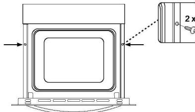
Ubacite rernu u ormarić tako što ćete je gurnuti napred. Otvorite vrata rerne i ubacite 2 šrafa u rupe koje su locirane na okviru rerne. Dok okvir proizvoda dodiruje drvenu površinu ormarića, zategnite šrafove.
