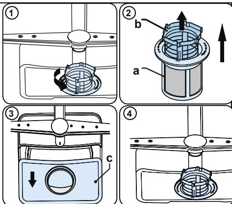
Da biste uklonili i očistili kombinaciju filtera, okrenite je u smjeru suprotnom od kazaljke na satu i uklonite je podižući prema gore (1). Izvucite grubi filter iz mikrofiltra (2). Zatim povucite i uklonite metalni filter (3). Isprati filter s puno vode sve dok ne ostane bez ostataka. Ponovno sastavite filtre. Zamijenite filterski umetak i zakrenite ga u smjeru kazaljke na satu (4).
